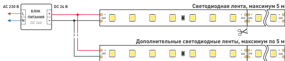
Рис.1. Подключение нескольких светодиодных лент с одной стороны
