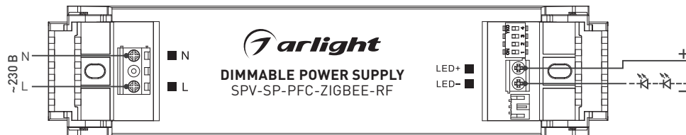
Рис. 1. Схема подключения для моделей 046171, 046173
