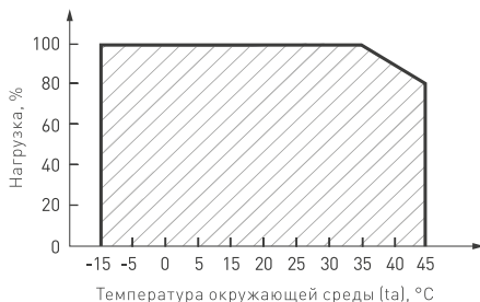
Рис. 2. Максимальная допустимая нагрузка, % от мощности источника
